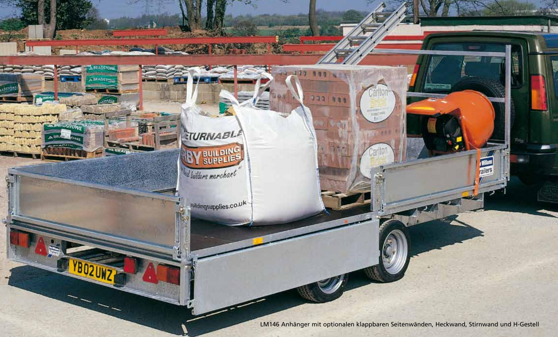
LM146 Anhänger mit optionalen klappbaren Seitenwänden, Heckwand, Stirnwand und H-Gestell
