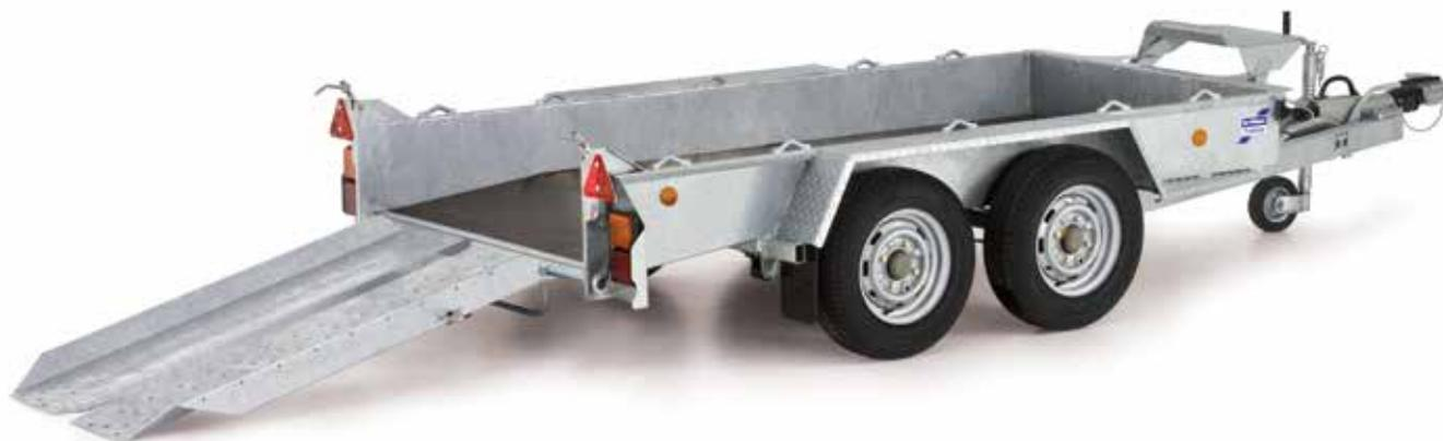
**GH1054** mit 1,20 m (3'9") langer Rampe über die komplette Breite und optionaler 12/24 V LED Beleuchtung
