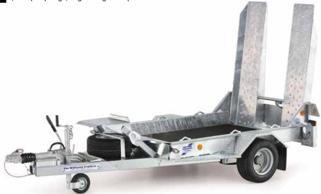
GH94 mit 195/55R10C Reifen und 1,20 m (3'9") Rampe mit Gitternetzfüllung und optionalen 12/24 V LED Beleuchtung
