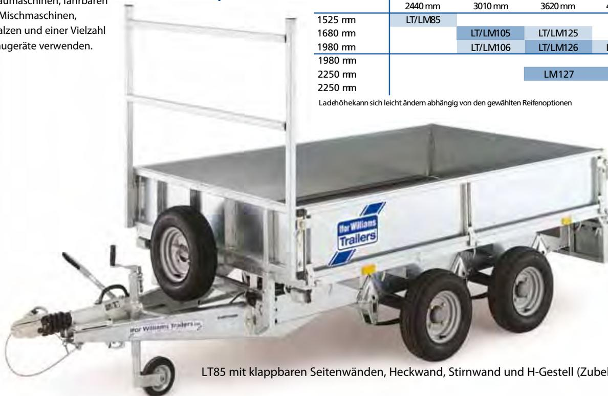
LT85 mit klappbaren Seitenwänden, Heckwand, Stirnwand und H-Gestell (Zubehör)
