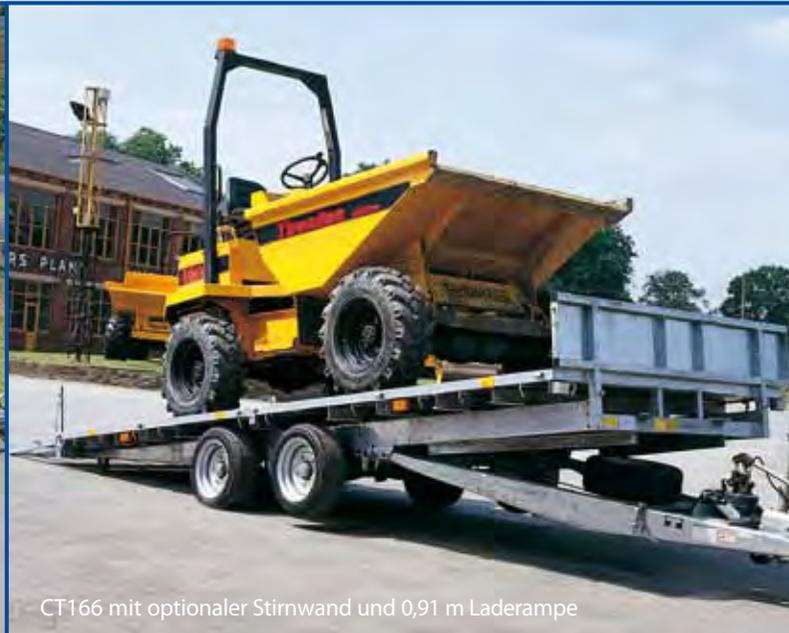
Der Kippanhänger ist die ideale Wahl für Besitzer von Fahrzeugen mit niedrigem Bodenabstand oder für Abschleppdienste. Er bietet alle Vorteile der Hochlader-Modelle, kombiniert mit einer leicht zu kippenden Ladefläche für bequemes Verladen.
