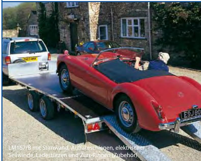
LM167/B mit Stirnwand, Auffahrschienen, elektrischer Seilwinde, Ladestützen und Zurr-Ringen (Zubehör)
