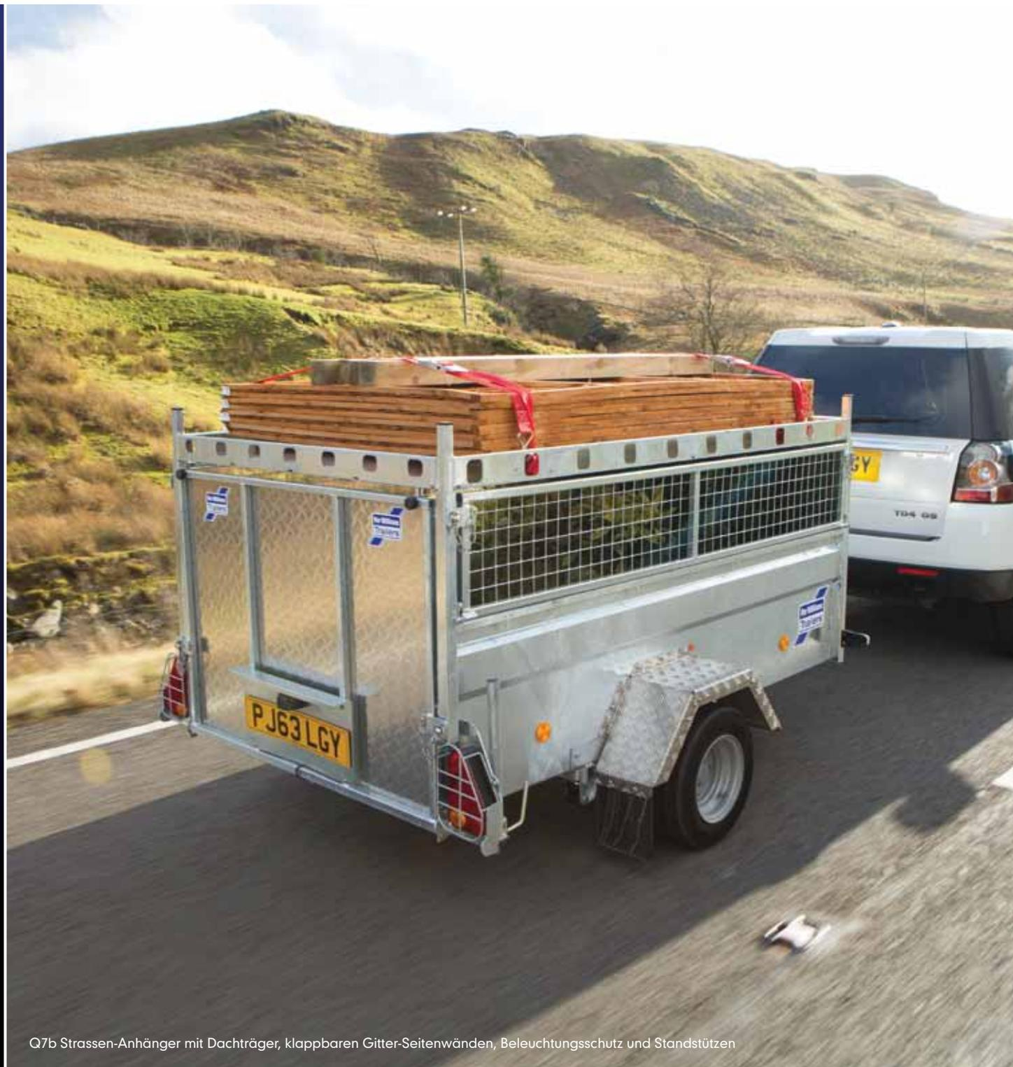
Q7b Strassen-Anhänger mit Dachträger, klappbaren Gitter-Seitenwänden, Beleuchtungsschutz und Standstützen
