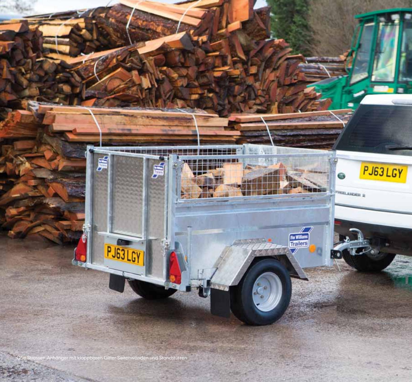
Q5e Strassen-Anhänger mit klappbaren Gitter-Seitenwänden und Standstützen
