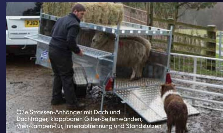
Q7e Strassen-Anhänger mit Dach und Dachträger, klappbaren Gitter-Seitenwänden, Vieh-Rampen-Tür, Innenabtrennung und Standstützen
