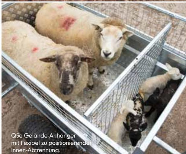
Q5e Gelände-Anhänger mit flexibel zu positionierender Innen-Abtrennung.
