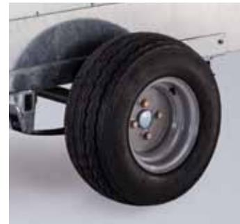
Q5/6/7e Gelände-Anhänger Flotation-Reifen (20,5 x 8-10)
