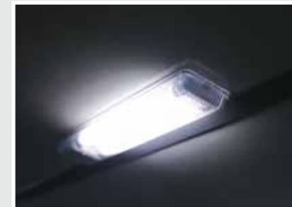
6. Zentrale Frontlampe im Arbeitsbereich gespeist durch das Zugfahrzeug oder die bordeigene Batterie.
