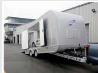
1. Über die Deichsel kippbarer Anhänger zum Verladen von Fahrzeugen mit geringer Bodenfreiheit.
