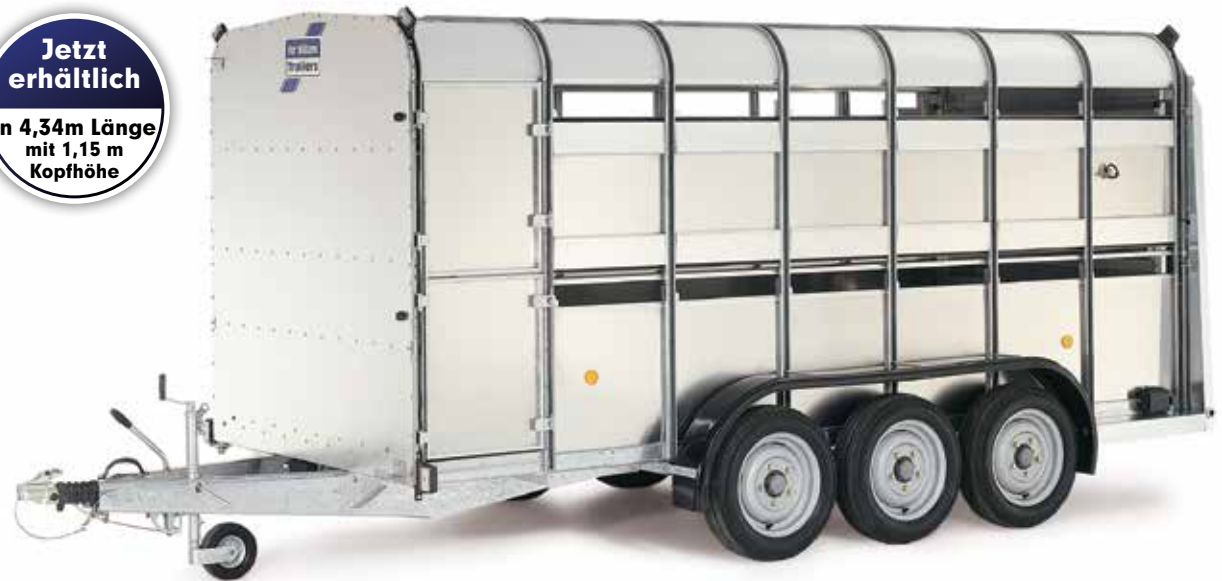
TA510 3,11 m Gesamtlänge (2,12m Kopfhöhe) mit optionaler unterer Belüftungsschiene
